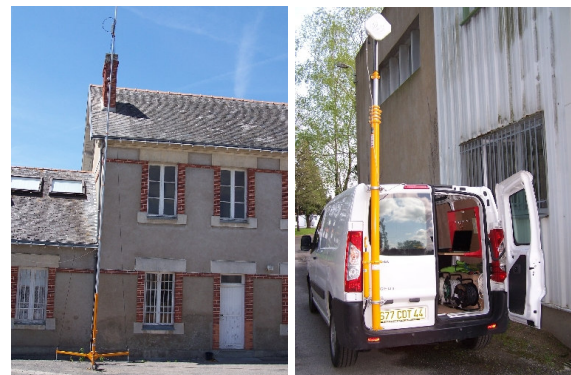
Mât sur trépied ou sur véhicule avec atelier embarqué
